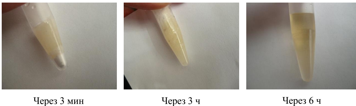
Рис. 23. Фотографии смеси микрокристаллической целлюлозы с [BMIm][Cl] в течение времени (температура термостата – 85°C).
