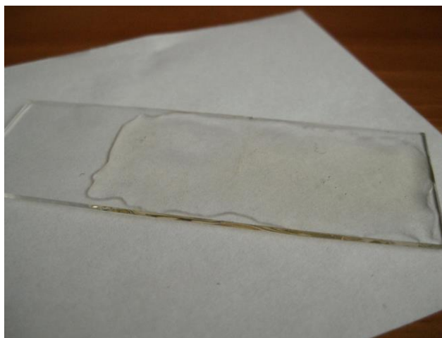
Рис. 24. Фотография целлюлозной пленки, полученной из раствора в [\text{BMIm}][\text{Cl}] , после выдерживания в холодильнике в течение 1 ч и промывания водой (содержание целлюлозы 4% масс., температура расплава 85^\circ\text{C} ).
