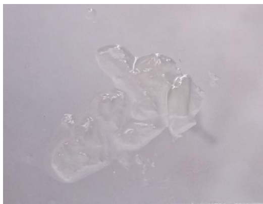
Рис. 26. Фотография целлюлозного материала, полученного из раствора в [BMIm][AcO], температура расплава 66°C, содержание целлюлозы 5% масс.
