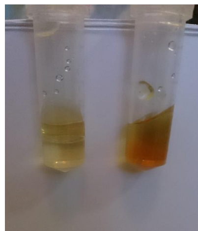
Рис. 29. Сравнение окрасок растворов целлюлозы в хлоридной ИЖ (слева) и ацетатной ИЖ (справа) при 85°C.
