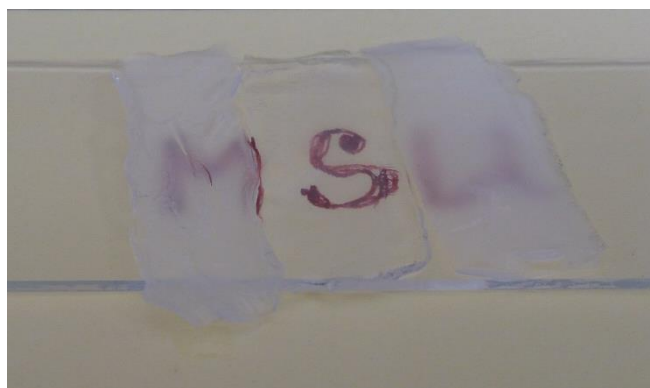
Рис. 35. Целлюлозные пленки, полученные растворением-осаждением из [BMIm][AcO], при использовании в качестве антирастворителя (слева направо) воды, этанола и ацетонитрила.
