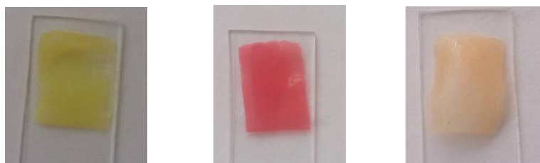
Рис. 72. Фотографии пленок состава {целлюлоза–[ВМІm][AcO]} с сорбированными куркумином , кармином и β-каротином (слева направо); рН 4.5; 6.5 и 5.5 соответственно, комнатная температура. Время сорбции – 24 ч.
