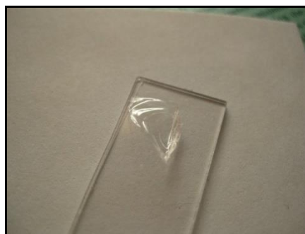
Рис. 48. Фотография пленки {целлюлоза–[BMIm][Cl]–ПХ} после ее высушивания на воздухе при комнатной температуре в течение одного дня.
