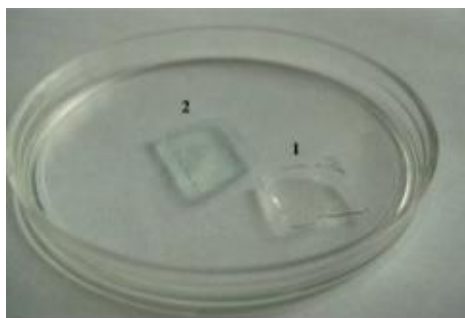
Рис. 51. Фото целлюлозной пленки, полученной из раствора {целлюлоза–[ВМІm][СІ]} без фермента (1) и с ПХ (2), через 2 мин после добавления 20 мкл 0.1 мкМ раствора ТМБ и 10 мкл Н 2 О.
