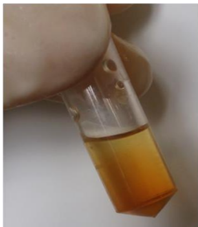
Рис. 28. Характерное бурое окрашивание раствора целлюлозы при ее растворении в ацетатной ИЖ при 85°C, свидетельствующее о деструкции полимера.
